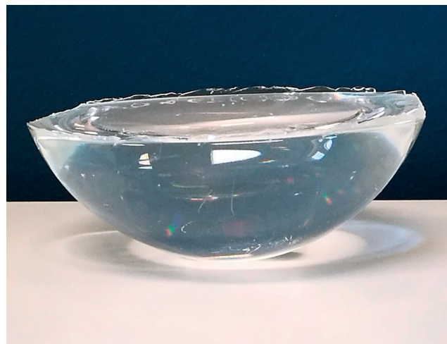
Bild 1. Transparentes Polystyrol aus chemisch recycelten Ausgangsstoffen. Nach dem Reißverschlussprinzip kann Polystyrol durch Hitze in Styrolmonomere zerlegt und wieder aufgebaut werden (© Ineos Styrolution)
