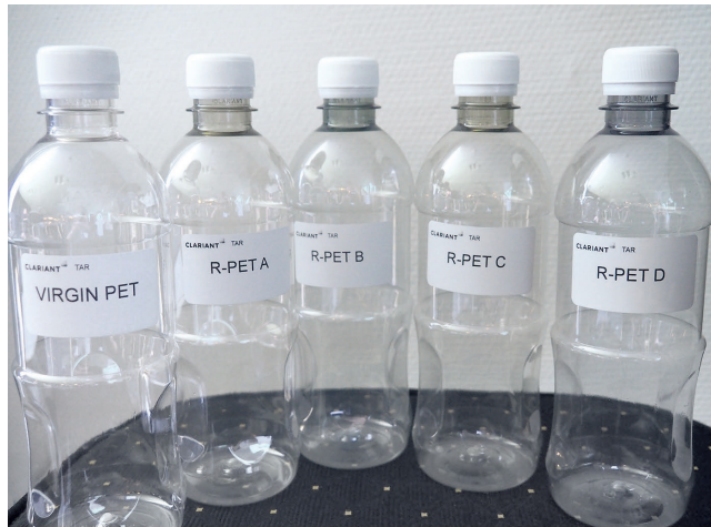
Bild 2. PET-Flaschen aus recyceltem Material sind aufgrund der heterogenen Ausgangsstoffe oft leicht verfärbt, was an den Flaschenhälften besonders deutlich wird. Clariant arbeitet an einem Masterbatch, das eine einheitliche Farbqualität ermöglicht
